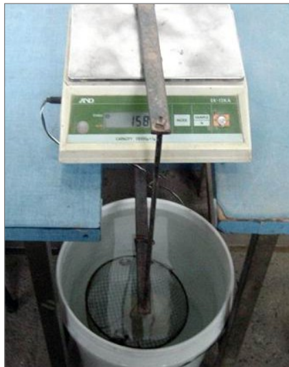
4. Pesamos la muestra sumergida (P3)
