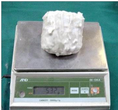
3. Pesamos la muestra recubierta con parafina (P2)
