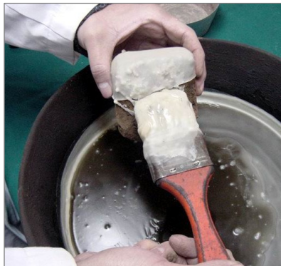
2. Recubrimos la muestra con una capa de parafina
